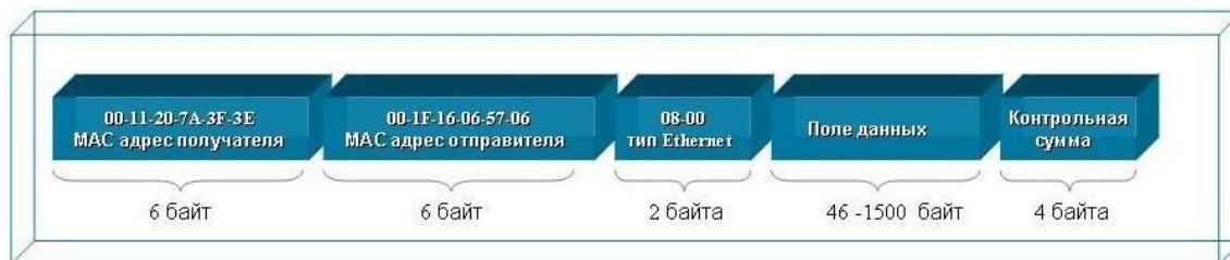
Рис. 86. Кадр Ethernet II (64-1518 byte)
