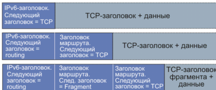
Рис. . Структура вложения пакетов для IPv6
